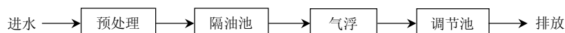
图 1 金属加工、轻工、油脂化工行业含油污水处理基本工艺流程图
